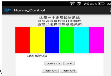
图 5 Android 智能家居(灯光)控制终端界面 Fig.5 Android smart home (LED) control terminal interface
