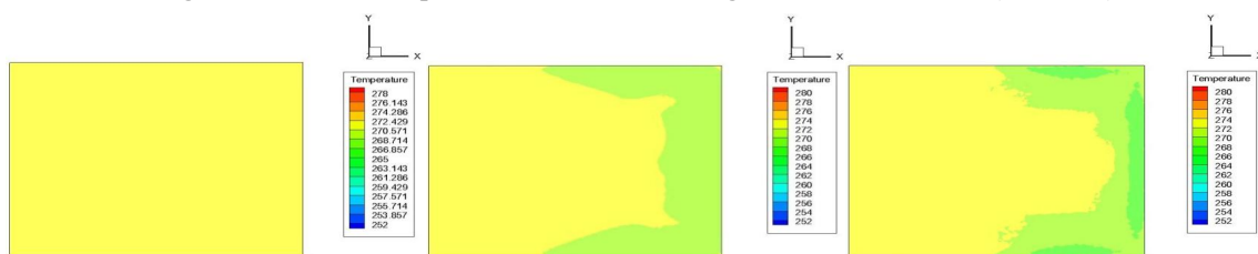
图 7 关门 10 s、20 s、30 s 的温度场截面图 ( Z=2.85\text{ m} )
