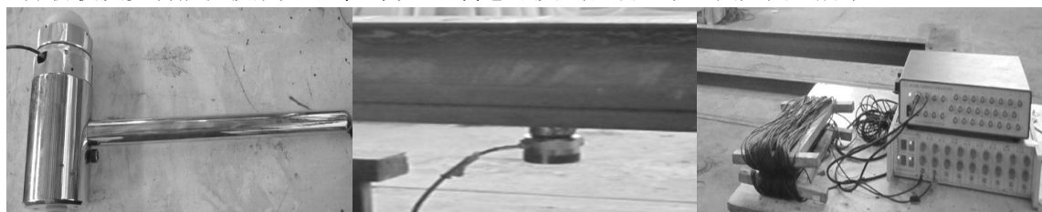
(a) 高弹性聚能力锤 High elastic force-hammer (b) 加速度传感器 Accelerated sensor (c) 试验装置 Test installations
