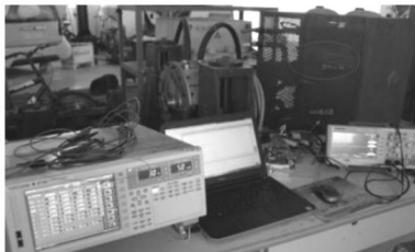
图 6 电机控制系统测试平台 Fig.6 Motor control system testing platform
